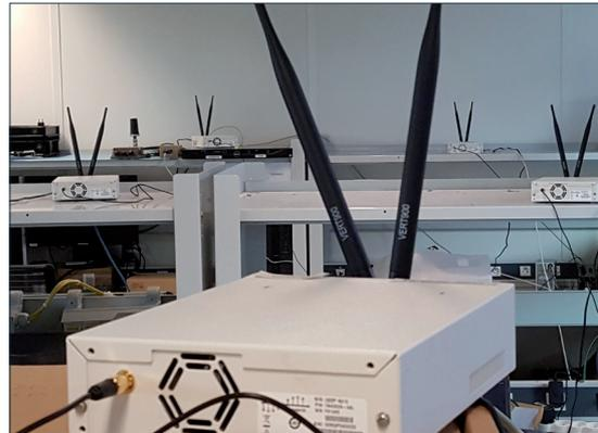
Banc de tests d'équipements de transmission sans-fil, utilisé pour la validation pratique de solutions de gestion des interférences proposées.
